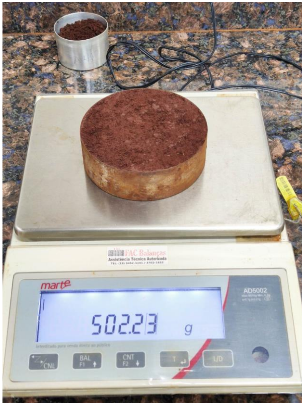
Figura 1 – Anel coletor com solo
