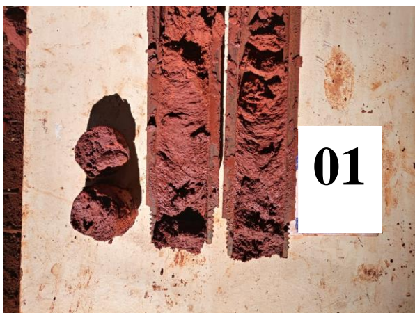
Figura 3 - Sonda com solo da Camada 3 (Furo 01)
