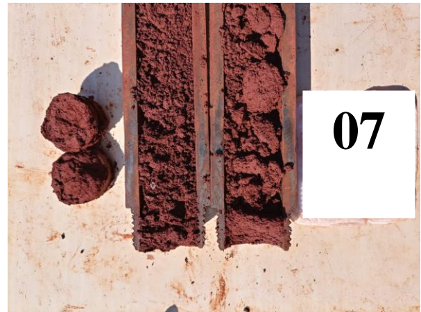
Figura 6 – Sonda com solo da camada 3 (Furo 07)
