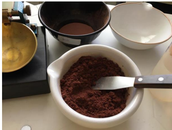
Figura 2 – Ensaio de Limite Liquidez em andamento
