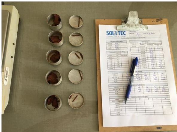
Figura 1 – Amostras de umidade
