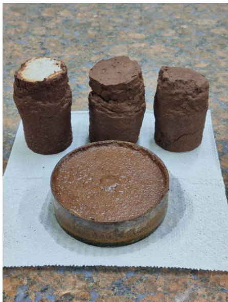
Figura 1 – Cilindros de solo extraídos após ensaiotriaxial
