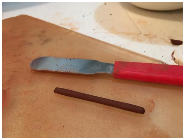
Figura 4 – Amostra de ensaio LP
