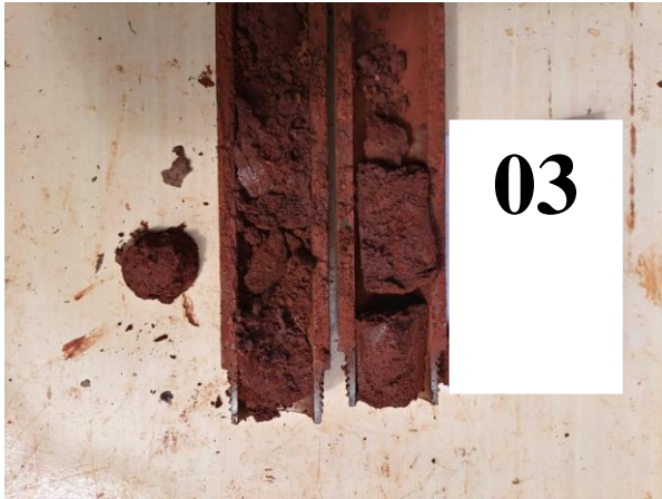
Figura 4 - Sonda com solo da Camada 3 (Furo 03)
