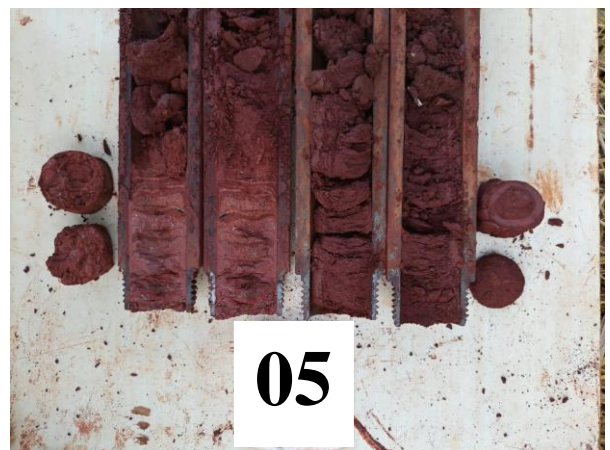
Figura 5 - Sonda com solo da Camada 3 (Furo 05)
