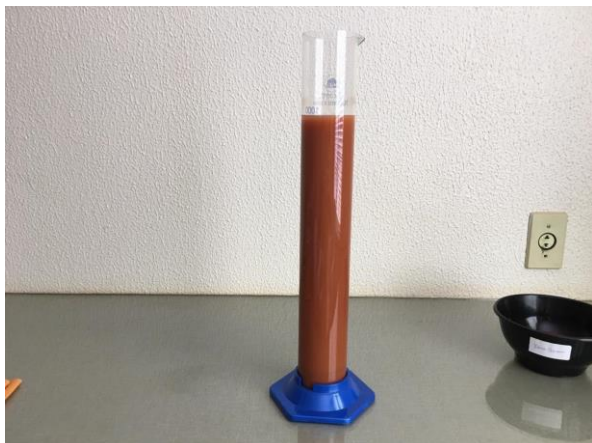
Figura 3 – Ensaio de sedimentação em andamento
